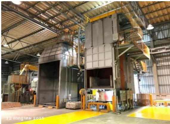
เครื่อง MRM สำหรับตั้งอลูมิเนียมในขั้นตอนการขึ้นรูปร่าง DROSS กลับไปหลอมใหม่
