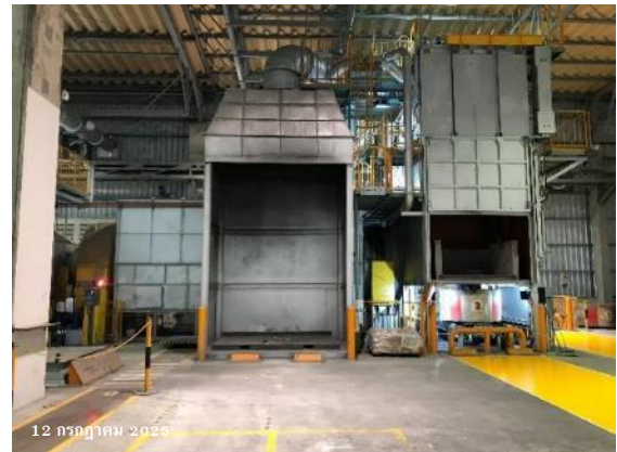
เครื่อง MRM สำหรับตั้งอลูมิเนียมในขั้นตอนการขึ้นรูปร่าง DROSS กลับไปหลอมใหม่
