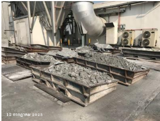
ถอดพักตะกรันอลูมิเนียม DROSS ก่อนนำไปจัดเก็บ
